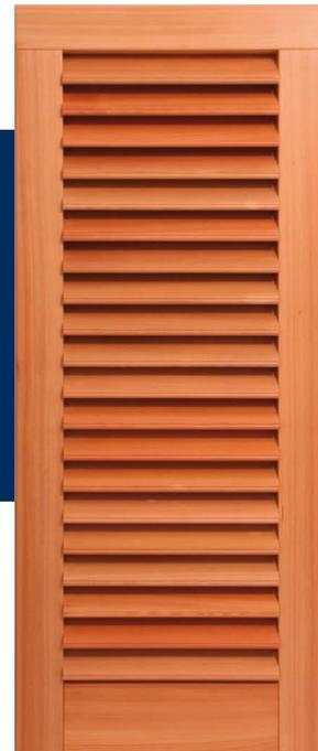
Der Typ Eifel zeichnet sich mit seinen profilierten überstehenden Lamellen durch eine sehr starke Licht-/Schattenstrukturierung aus. Die unter 45° stehenden 74 mm breiten Lamellen sind durch den Mittenabstand von 50 mm auf eine sehr gute Licht- und Luftdurchlässigkeit hin konzipiert.
